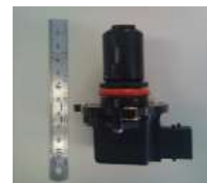
尿素水識別センサー (尿素水タンク取付品)
